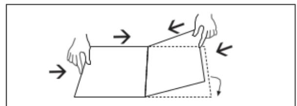
Utilizzare i soliti metodi di installazione per la moquette per livellare le giunture, nonché l'intera superficie in generale, come i rulli, ecc.
